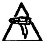
**ADVERTENCIA:** Poner en marcha o encender sin querer el elemento calentador tras haber actuado el relé térmico puede producir lesiones. Asegúrese de que el interruptor está apagado, en posición OFF, cuando conecte el aparato a la red.
