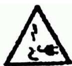
**AVVERTENZA:** Un cavo di alimentazione danneggiato può causare una scossa elettrica pericolosa. Controllare regolarmente il cavo di alimentazione. Non azionate l'unità se il cavo di alimentazione è danneggiato. Sostituire sempre un cavo danneggiato tramite uno specialista. Non avvolgere il cavo intorno all'unità e proteggerlo da olio, calore e bordi taglienti. Non trasportare l'unità dal cavo e non utilizzare il cavo per tirare la spina dalla presa.
