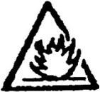
**AVVERTENZA:** Pericolo di fuoco! Il calore può raggiungere materiali combustibili che sono nascosti dietro i rivestimenti, nei soffitti, nei pavimenti o nelle cavità, e accenderli. Ispezionare l'area di lavoro prima di iniziare a lavorare e, in caso di dubbio, astenersi dall'uso della pistola ad aria calda. Non puntare l'unità nello stesso punto per lunghi periodi di tempo.
