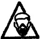
**AVVERTENZA:** Pericolo di intossificazione! Durante la lavorazione di materie plastiche, vernici o simili, si sviluppano gas che possono essere aggressivi o tossici. Evitare di respirare i vapori, anche quando sembrano innocui. Fornire sempre una buona ventilazione dell'area di lavoro o indossare un respiratore.
