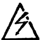
**AVVERTENZA:** Un involucro danneggiato o un apparecchio aperto può portare a una scossa elettrica pericolosa. Non aprire l'apparecchio e non attivare un'unità danneggiata. Non forare l'involucro, ad es. per attaccare un'etichetta dell'azienda. Prima di eseguire qualsiasi operazione sull'unità, togliere la spina dalla rete elettrica.
