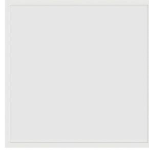
Pannello LED bianco 600 x 600 130 lm/W UGR19 4000 K IRC 80 IP20. Potenza regolabile: 26/31,2/36,4 W. Flusso luminoso 3300/4000/4600 lm. Montaggio ad incasso, uso interno, driver incorporato. Dimensioni: 595 x 595 x 32 mm.
